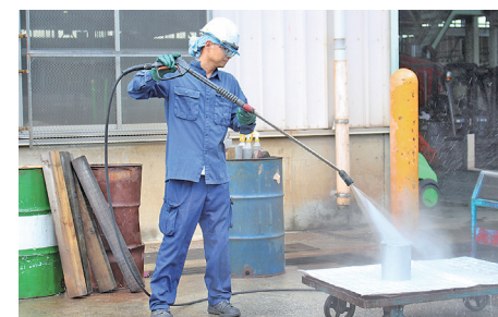
高圧温水洗浄を行う
