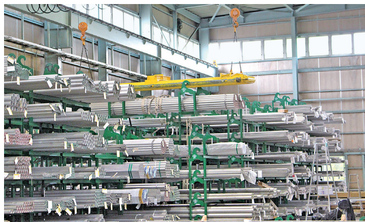
定尺材保管でクレードルラックを活用
